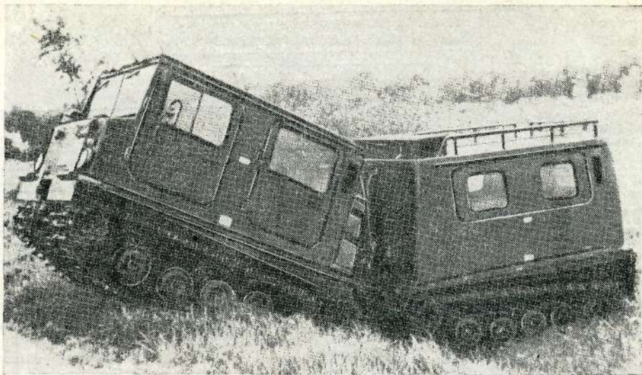
Рис. 3. Сочлененный гусеничный транспортер Bv206
